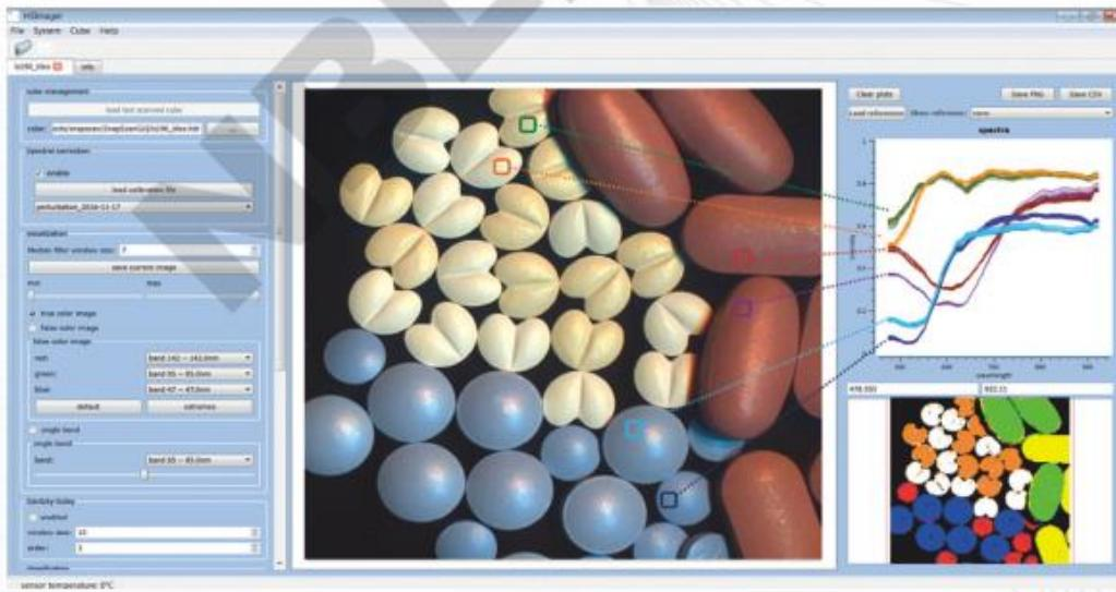
上图为SNAPSCAN的数据采集软件界面，中间为由高光谱数据合成的RGB彩色图象，右上角为不同药片的光谱曲线，右下角为光谱分类的伪彩色图象
